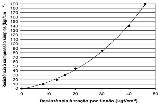
**Gráfico 1** – Relação empírica para a resistência à compressão e resistência à tração.
